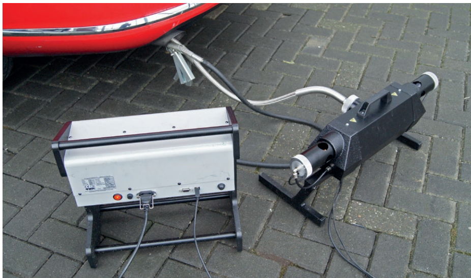
Figuur 14. In het onderzoek van 2016 zijn de absorptiecoëfficiënten gemeten met twee typen rookmeter: een conventionele of 'standaard' rook- of opaciteitsmeter zoals die nu wordt gebruikt in de APK (rechts) en een moderne, 'verbeterde' rook- of opaciteitsmeter (links), met een hogere nauwkeurigheid dan de oude meters. Een roetmeting wordt uitgevoerd 'bij vrije acceleratie': het gaspedaal wordt maximaal ingetrapt en zo wordt de maximale rookemissie gemeten (foto: TNO).
